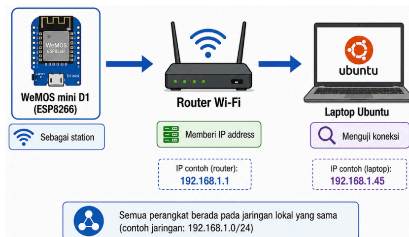
Gambar 6.1 WeMOS mini D1 tersambung ke router sebagai station dan dapat diuji dari laptop Ubuntu dalam jaringan yang sama.
